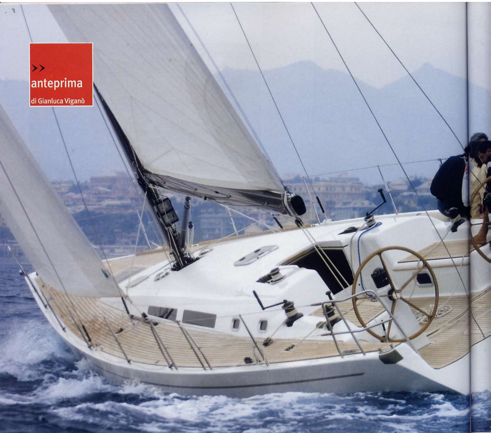
A sinistra, il pozzetto, caratterizzato dalla doppia timoneria, ha il trasto della randa fissato sul calpestio per facilitare il passaggio verso poppa. Sotto, il tavolo abbassato forma un comodo prendisole.
