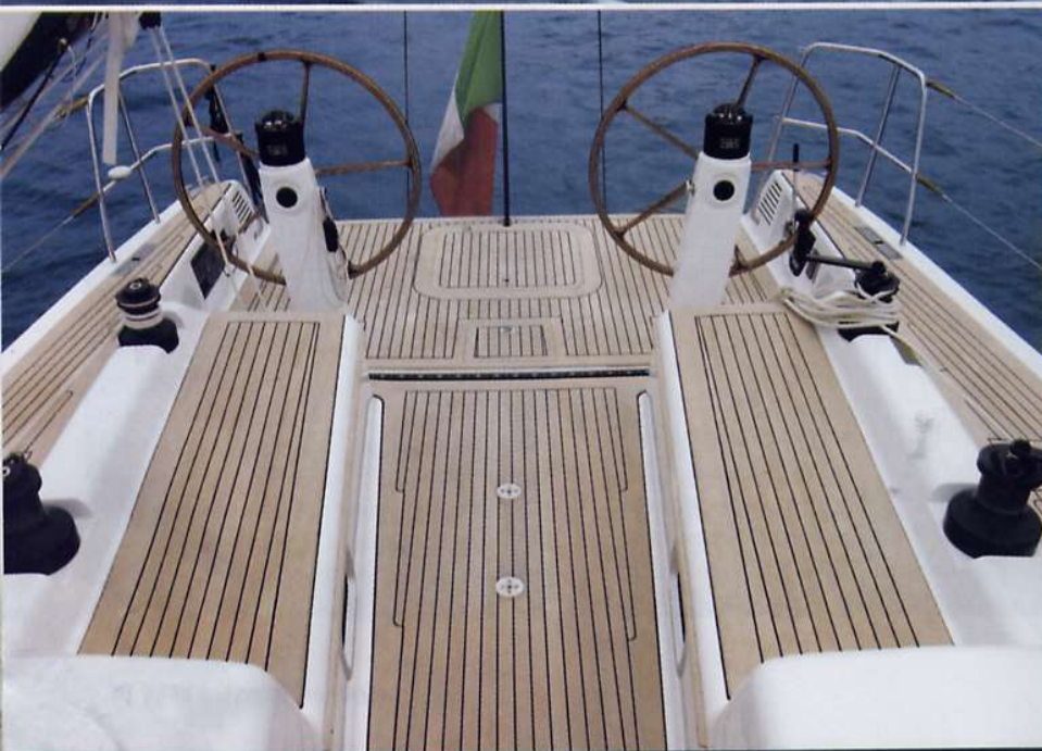
A sinistra, il pozzetto, caratterizzato dalla doppia timoneria, ha il trasto della randa fissato sul calpestio per facilitare il passaggio verso poppa. Sotto, il tavolo abbassato forma un comodo prendisole.
